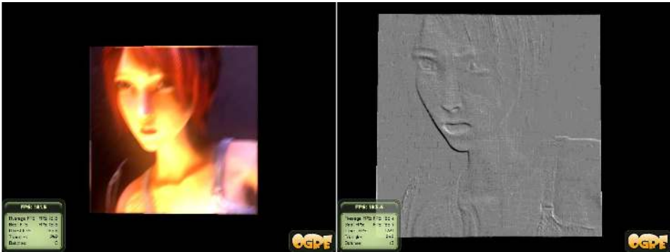
Figura 7.27: A la izquierda, efecto borroso ( blur ). A la derecha, efecto gravado en piedra.
