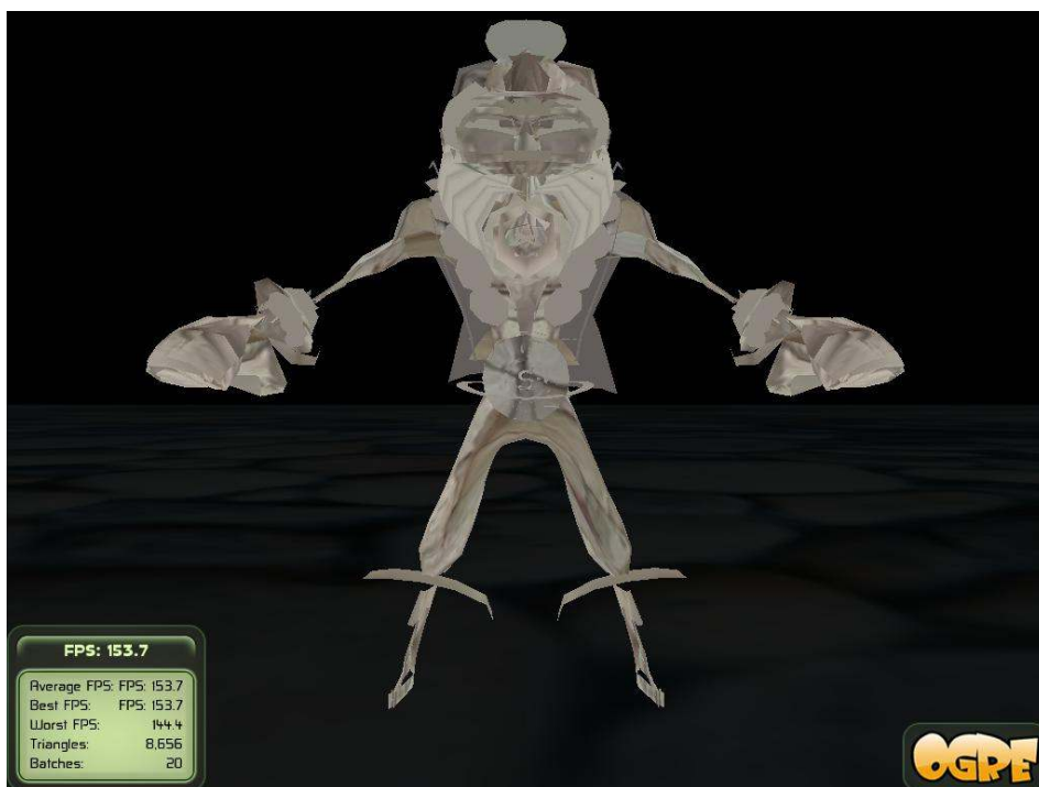
Figura 7.30: Figura con sus vértices desplazados en dirección de sus normales.
