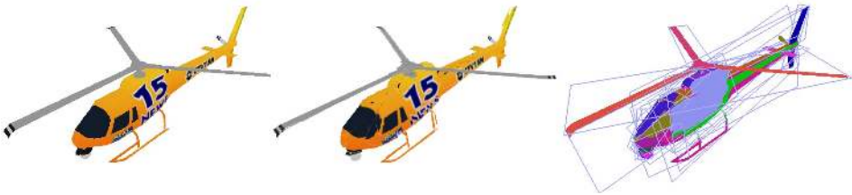
Figura 7.8: Modelado de un helicóptero mediante nube de billboards.
