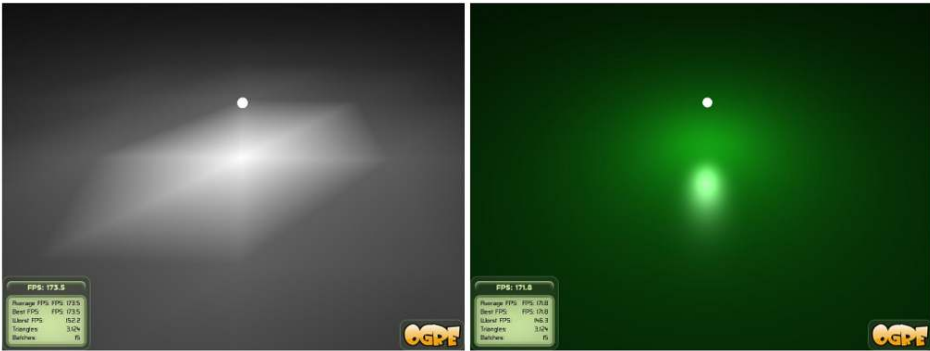
Figura 7.17: Diferencia entre Per-Vertex Lighting (izquierda) y Per-Pixel Lighting (derecha).
