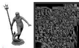
Figura 9.10: Despliegue del modelo de Neptuno empleando Lightmap Pack . Cada cara poligonal tiene asociado un espacio propio en la textura.
