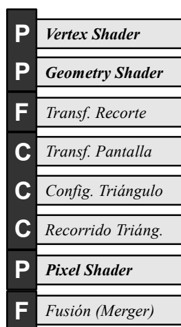
Figura 1.11: Implementación típica del pipeline en GPU con soporte Híbrido (OpenGL 2). La letra asociada a cada etapa indica el nivel de modificación permitida al usuario; P indica totalmente programable, F indica fijo (no programable), y C indica configurable pero no programable.
