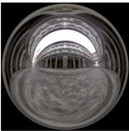
Figura 8.10: Mapa de entorno esférico empleado para simular la reflexión de un supuesto mundo.
